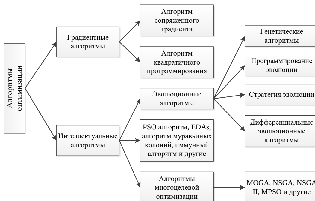
Рис. 2. Алгоритмы оптимизации для проектирования электрических машин
