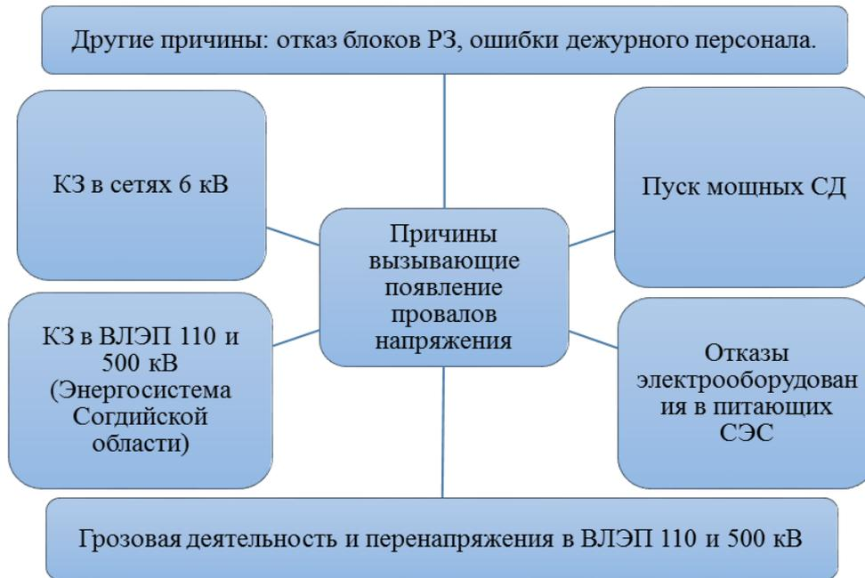
Рис. 3. Основные факторы влияющие на режимы работы узлов нагрузки энергосистемы Ходжа-Бакирган
