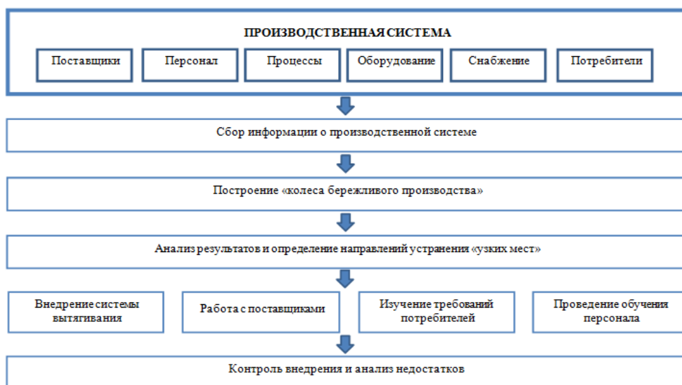
Рис. 4. Алгоритм развития производственной системы на основе построения «колеса бережливого производства»
