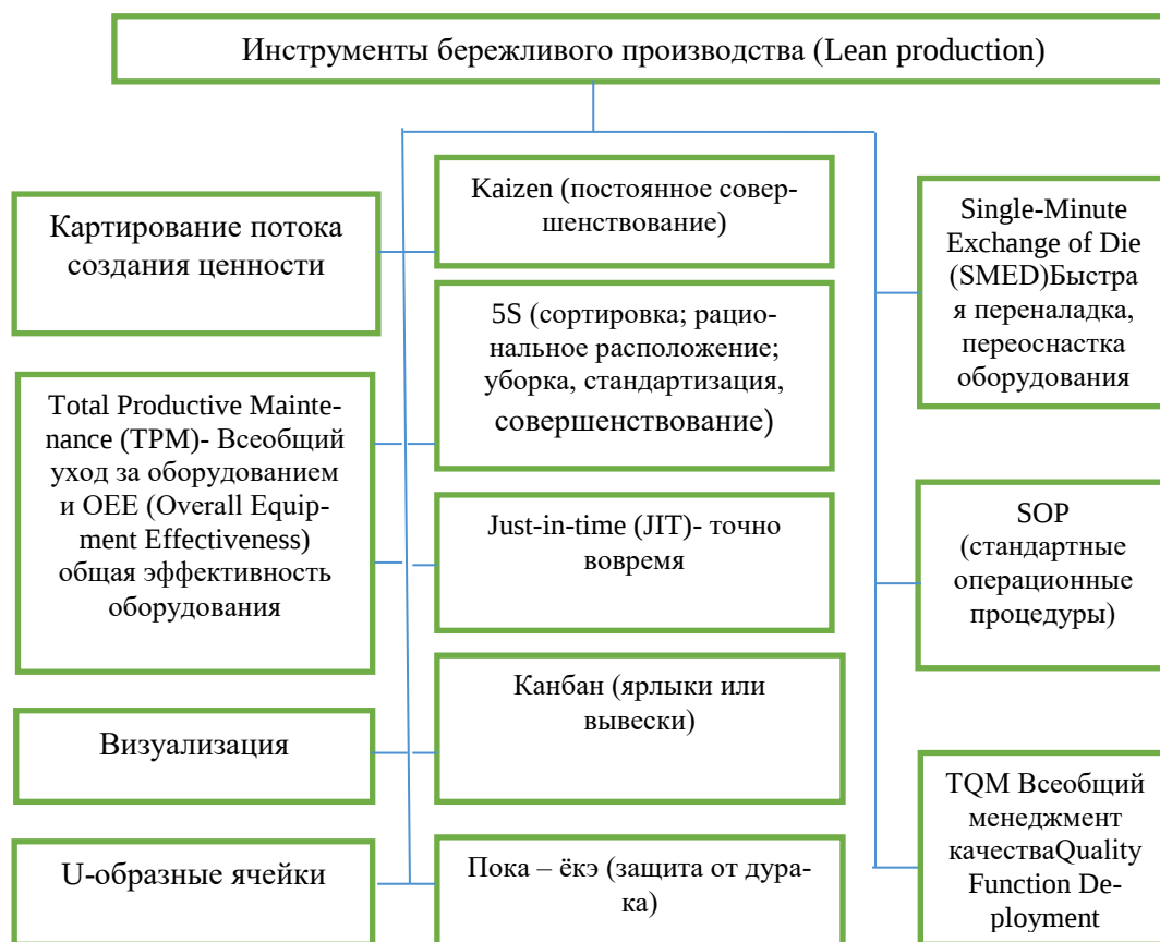
Рис. 2. Инструменты бережливого производства 1
