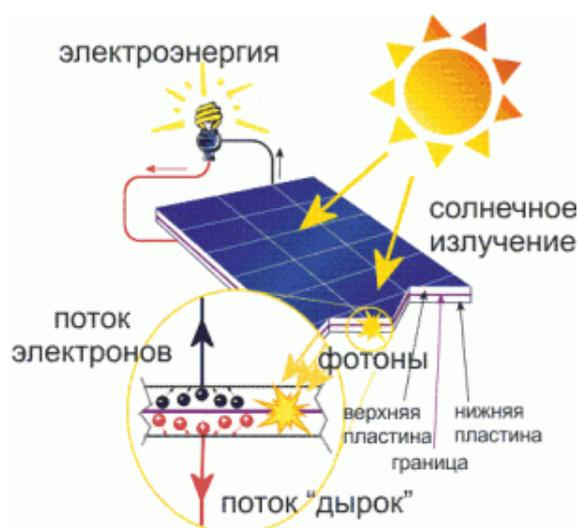
Рис. 6. Схема преобразования солнечной энергии в электрическую энергию
