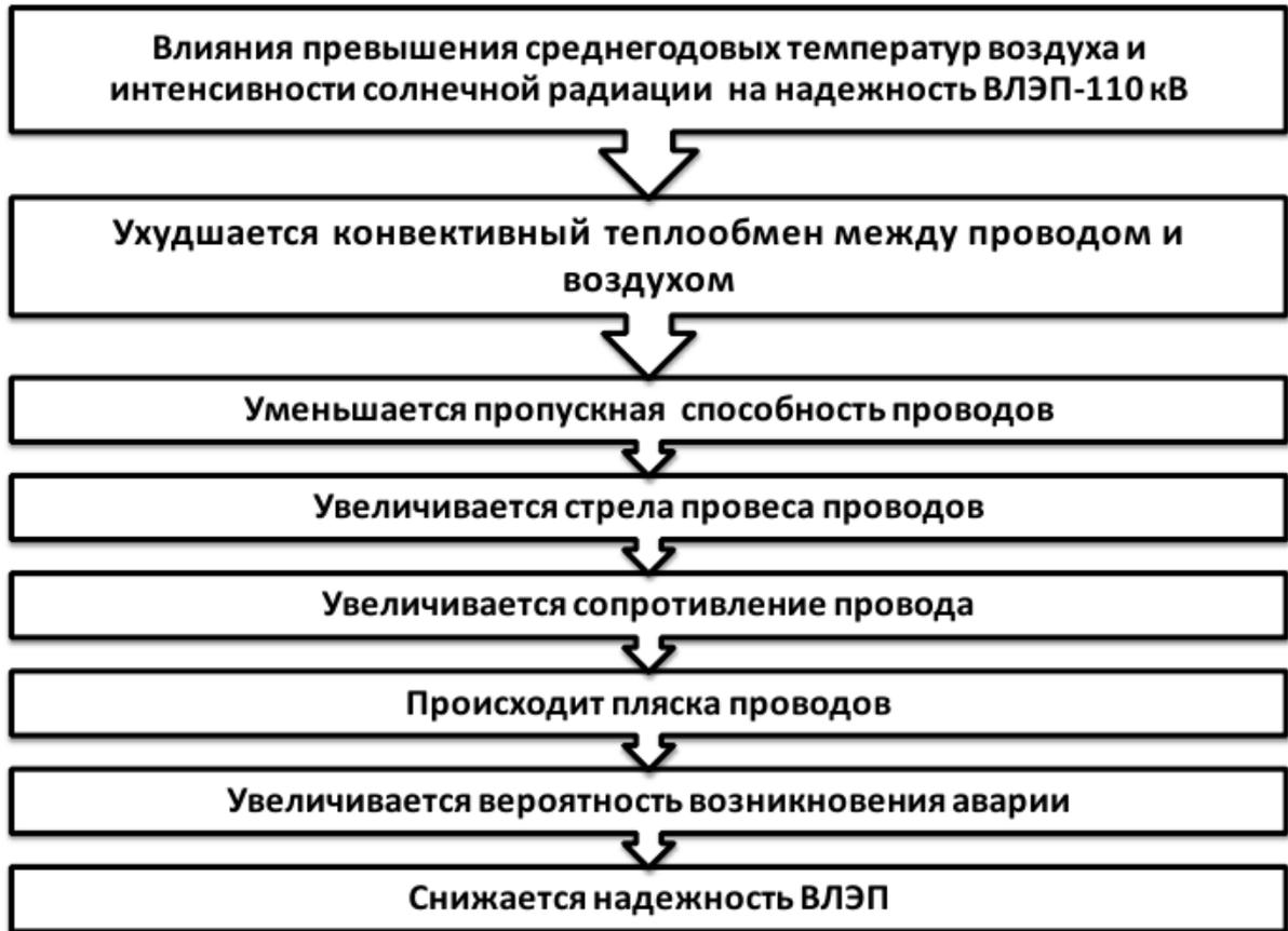
Рис. 1 - Влияние температуры окружающего воздуха и солнечной радиации на надежность ВЛЭП-110 кВ
