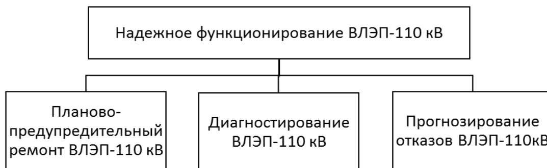
Рис. 1. Факторы обеспечения надежного функционирования ВЛЭП-110 кВ
