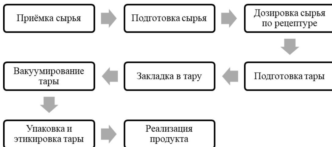
Рисунок 1. Блок-схема производства сухих смесей с добавлением концентрата боярышника
