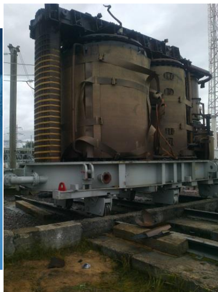
Рисунок 3. Повреждения трансформаторов электрической дугой внутри бака трансформатора: а) — повреждение бака трансформатора под воздействием электрической дуги; б) — обгоревшая магнитная система трансформатора
