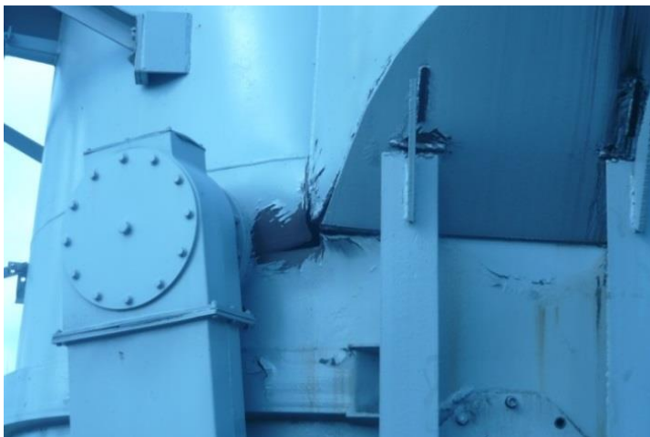
Рисунок 3. Повреждения трансформаторов электрической дугой внутри бака трансформатора: а) — повреждение бака трансформатора под воздействием электрической дуги; б) — обгоревшая магнитная система трансформатора
